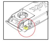
Die Wildcat Realizm 800 (die den High-End Stromversorgungsspezifikationen für x16 PCI Express Grafikbeschleuniger entspricht) verwendet eine Stromversorgung über das Netzteil mit einem besonderen High-End Stromstecker, der speziell für den Anschluss an eine x16 PCI Express Grafikkarte entwickelt wurde.
