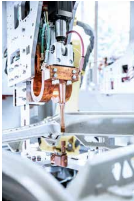
Die modular konzipierte DeltaCon-Zange zum Punktschweißen ist für Aluminium-Anwendungen optimiert.
