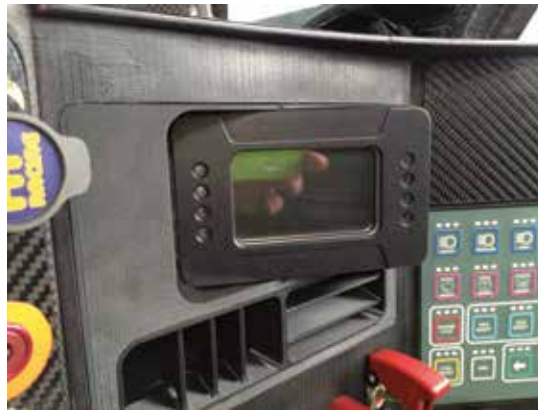
Hochwertige Einzelfertigung: Einsatzfähige Instrumententafel für einen Rennwagen, in thermoplastischem Material gedruckt.
