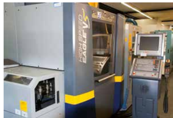
Für die Grafitbearbeitung sind bei Lindecke zwei 3-achsige HSC-Maschinen sowie die hier zu sehende 5-achsige OPS Eagle V5 zuständig, die mit Nullpunktspannsystemen und Werkzeugstückwechslern ausgerüstet sind. Das Fräsarbeitsblatt wird auch im Grafitbereich von Visi automatisch generiert.
