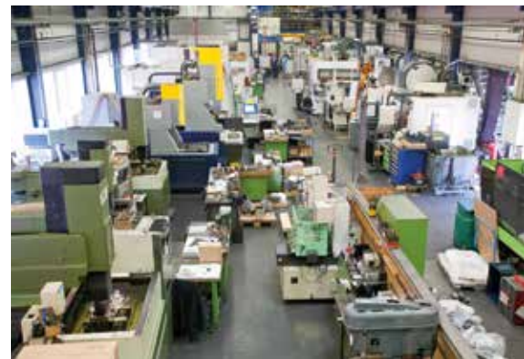
Die Fertigungshalle von Bernd Lindecke Werkzeugbau: Hergestellt werden 1K- und 2K-Spritzgießwerkzeuge in unterschiedlicher Bauart mit einem Gesamtgewicht von bis zu 15 Tonnen.
