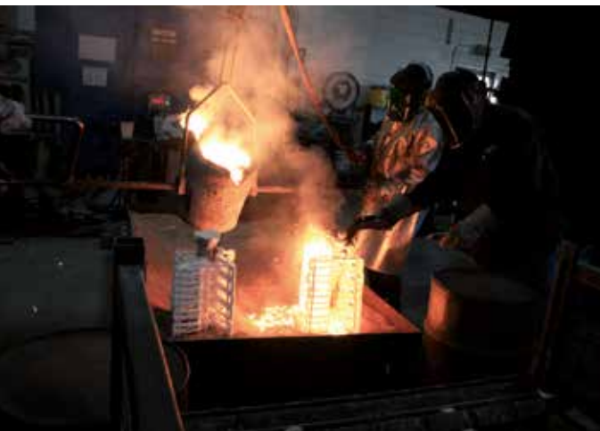
Die Herstellung der Sitzrahmen erfolgt im klassischen Metallgussverfahren. Bilder: Autodesk
