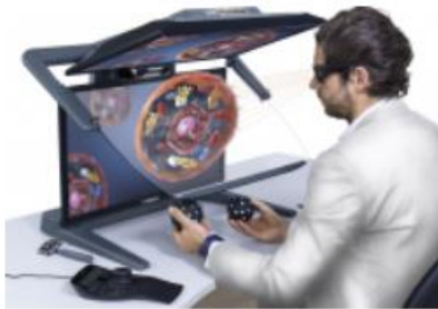
Der innovative, passive 3D-Stereo Monitor 3D PluraView verfügt über einen weiten Betrachtungswinkel
