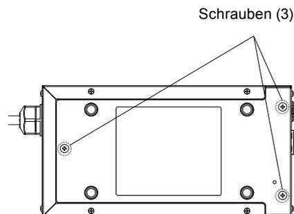
Bringen Sie das Netzteil so an, wie es unten gezeigt wird, und benutzen Sie die entfernten Schrauben. Bringen Sie das Netzteil nicht in der falschen Ausrichtung an.
