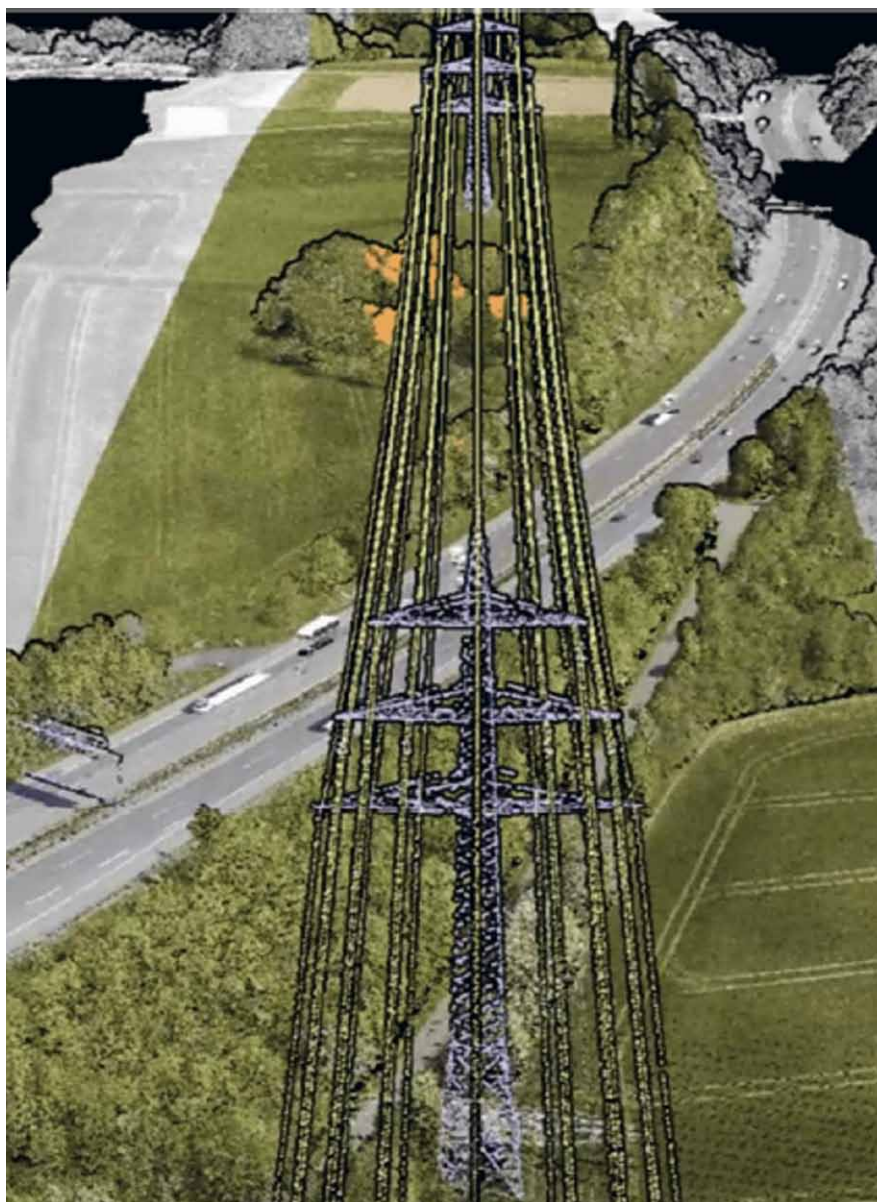
Bild 6. Exempel på punktmolnet visualiserat RGB-färg från bilder. Stolpar och ledningar har tilldelats en vald specifik färg för att förstärka den visuella informationen. Området utanför bildernas täckning har tilldelats färg från intensiteten.
