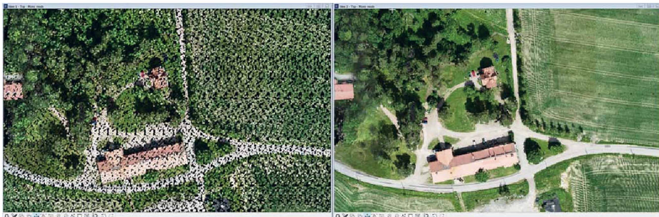
Bild 5 Till vänster är punktmolnet visualiserat med en RGB-färg per punkt, till höger samma punktmoln med en textur per punkt. Punktmolnet har ca 1 punkt/m 2 och bilderna ca 2 cm upplösning.
