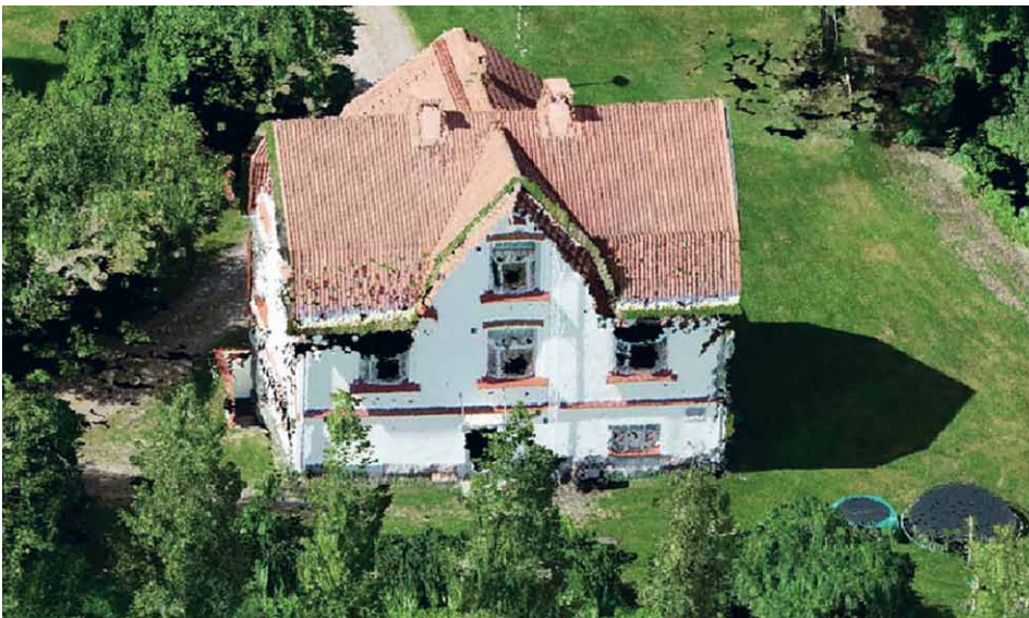
Bild 4 Vid texturering av punkter används även normalriktningen vilket gör att varje punkt kan avbildas som en vriden yta. Det gör att både mark, väggar och tak kan textureras på ett intelligent sätt.
